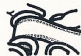
(ハ) フィルムの膜面を内側にして堅く巻き、ゆるい時は内側に入らなさいともあり、あとから巻きしめますとフィルム面に傷がつきます。
